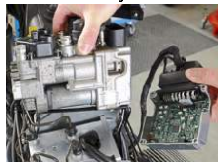
Aufwendig: Teststand bei RH Electronics für reparierte BMW-Steuergeräte mit CAN-Bus Integral-ABS I. Er simuliert Signale von Raddrehzahlen, Tacho und Bremslicht. Letzter Lösungsweg: radikaler Umbau auf ein RH-Steuergerät ohne ABS/BKV
