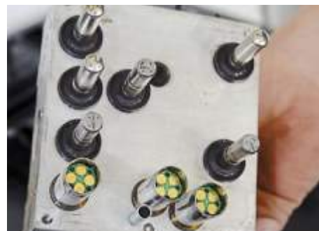
Goldfinger: Defekte an keramischen Drucksensoren setzen den FTE-Hydroblock mit Bremskraftverstärker mitunter schachtmatt
