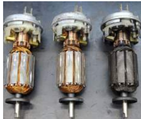
Oxidation: Wicklungen der E-Motoren an Hydraulikpumpen sind aus reinem Kupfer. Rechts: Motor verbrannt nach Kurzschluss
