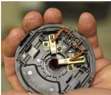
Kleine Ursache, großer Ärger: (Ungleich) abgenutzte Kohlen in E-Motoren machen ein neues Hydro-Aggregat erforderlich!
