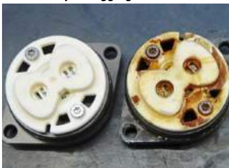
Autsch! Wasser in der Bremsflüssigkeit führte zu Rost, der die empfindliche Hydraulikpumpe aus Keramik beschädigt hat
