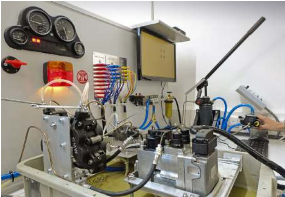
Aufwendig: Teststand bei RH Electronics für reparierte BMW-Steuergeräte mit CAN-Bus Integral-ABS I. Er simuliert Signale von Raddrehzahlen, Tacho und Bremslicht. Letzter Lösungsweg: radikaler Umbau auf ein RH-Steuergerät ohne ABS/BKV
