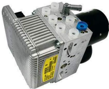
RH Electronics repariert die SBC-Bremse bei typischem Fehler C249F – und setzt nicht nur den Fehler zurück, sondern überholt die komplette Einheit.
