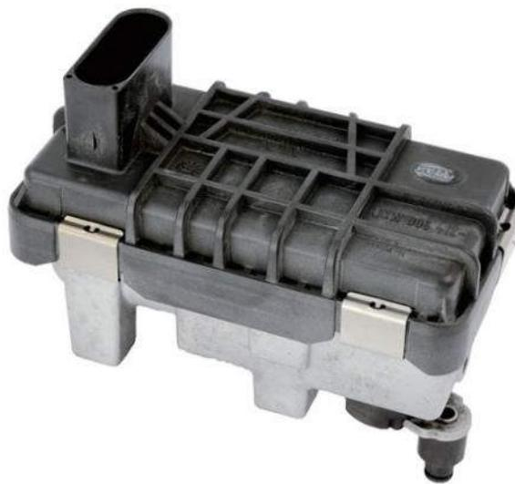
Turbostelleinheit: Häufig liegt das Versagen eines Turboladers an der elektrischen Stelleinheit. In diesem Fall ist die Reparatur der Einheit kostengünstiger als ein komplett neuer Turbolader.
