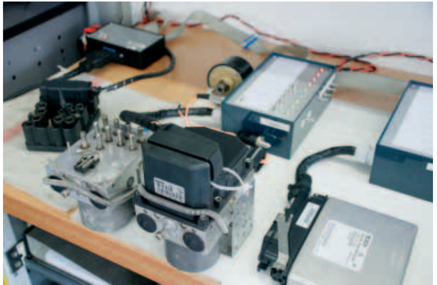
Prüfplatz: Das instandgesetzte Steuergerät ist an den passenden Adapter angeschlossen und prüfbereit.
