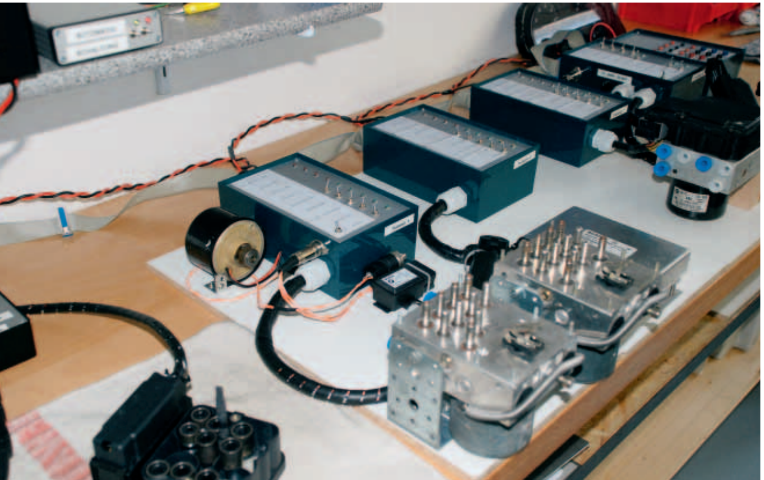
Gewusst wie: Mit Hilfe vieler selbst entwickelter oder der Kfz-Werkstatt entlehnter Hilfsmittel und Werkzeuge setzt RH Electronics ABS- und ESP-Steuergeräte instand. Bilder: Mareis
