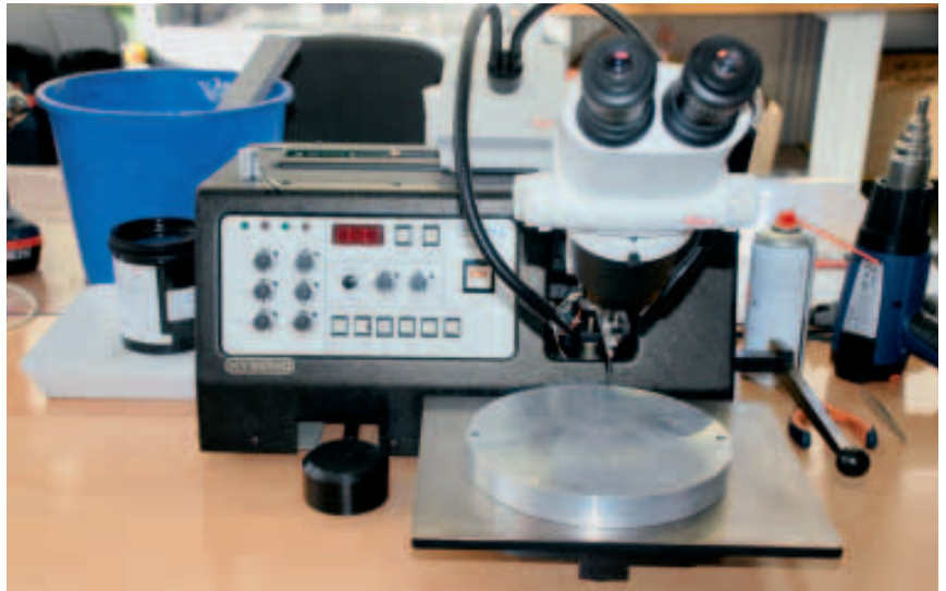
Feinarbeit: Eine spezielle Bonding-Maschine ermöglicht professionell auch feinste Verdrahtungsarbeiten.
