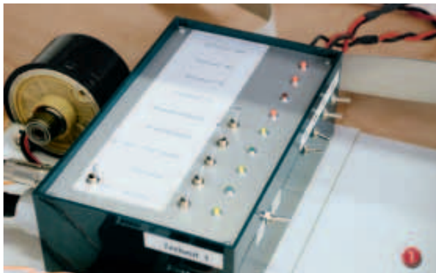
Ursache und Wirkung: Der umgelegte Schalter an der Prüfbox (1) simuliert eine Unterbrechung eines Drehzahlsensors, was das Steuergerät ordnungsgemäß erkennt und an das Diagnosetool (2) weitermeldet.
