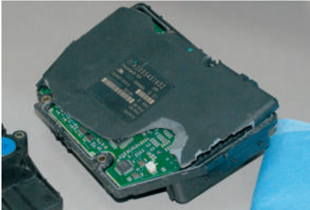
Dreck im Schachterl: Mangelhaft verpackte Steuergeräte erreichen oft so den Instandsetzer, hier hilft nur noch ein Neuteil. Bild: Mareis
