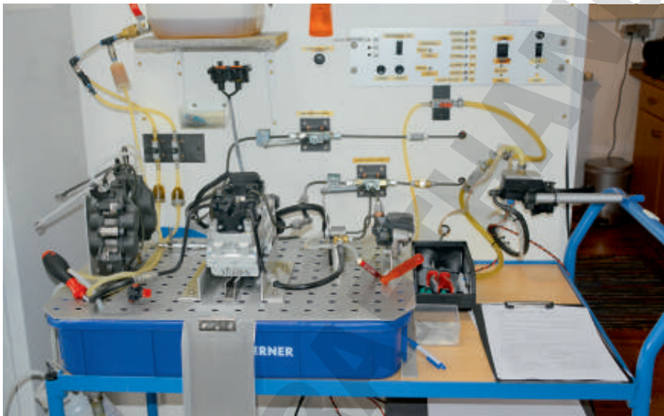
Motorrad-ABS: Auch für Zweiräder hat RH Electronics umfangreiches ABS-Prüf- und Reparaturrequipment im Haus. Bild: Mareis
