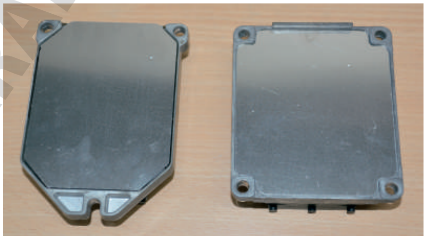
Deckel drauf: Nur professionell geöffnete Steuergeräte lassen sich nach der Reparatur auch wieder so verschließen, dass sie im Fahrbetrieb nicht erneut Schaden nehmen. Bild: Mareis
